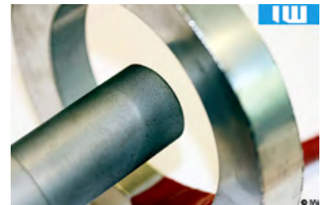
Mit Hilfe der Wirbelstrommessung können die Randzoneneigenschaften beim Drehen definiert eingestellt werden. (Foto: Lara Fricke/IW)
