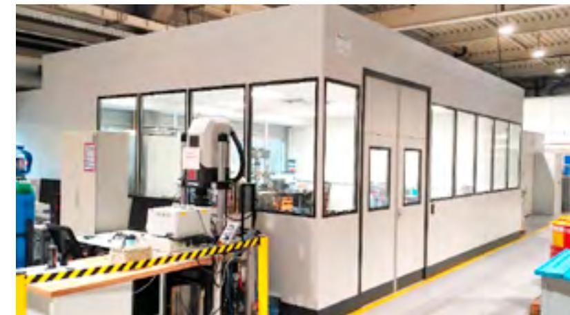
Neu im IW: Einhausung für die Materialprüfung, Metallographie-Kamera DP74. Fotos IW
