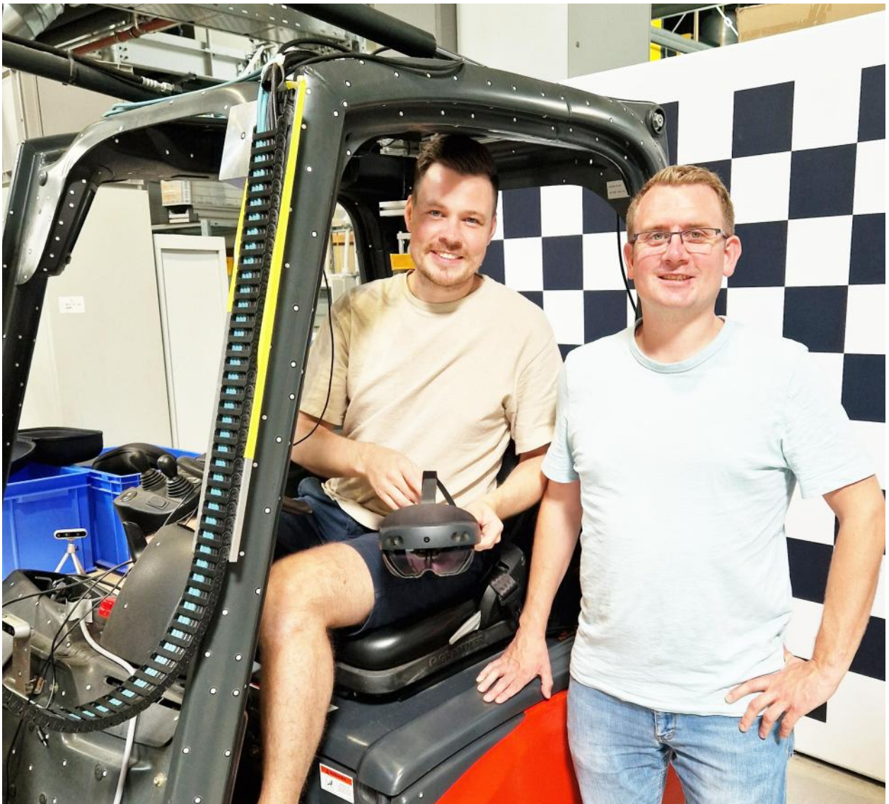
Modifizierter Gabelstapler, der durch den Einsatz von Kamera- und Sensortechnik sowie einer AR-Brille einen Beitrag für eine effizientere und sicherere Lagerlogistik leistet. Links: Birger Reitz, rechts: Sebastian Leineweber. Foto: ITA
