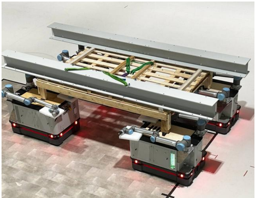
Links: „Soft Material Robotic Systems“ – die Verwendung weicher Materialien verringert die Verletzungsgefahr. Rechts: Transport großer Bauteile durch kooperierende, mobile Roboter. Fotos: match
