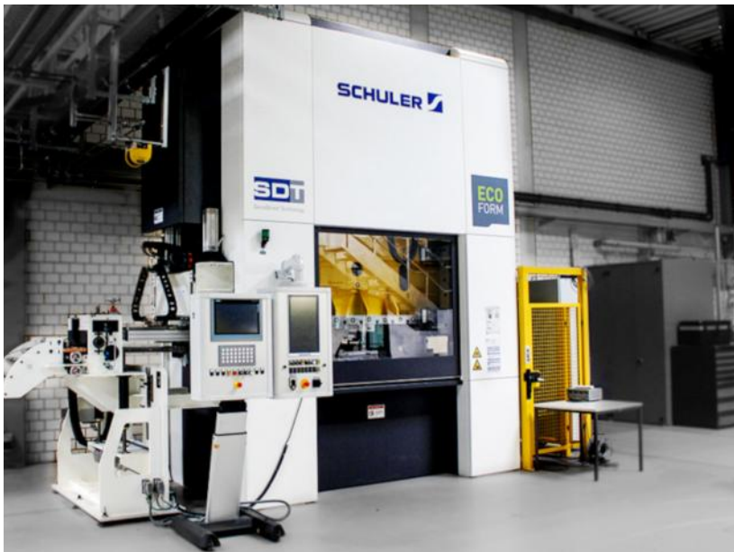
Um Messdaten zu generieren, wird der Transferwerkzeugsatz in die Versuchspresse am IFUM eingebaut. Foto: IFUM
