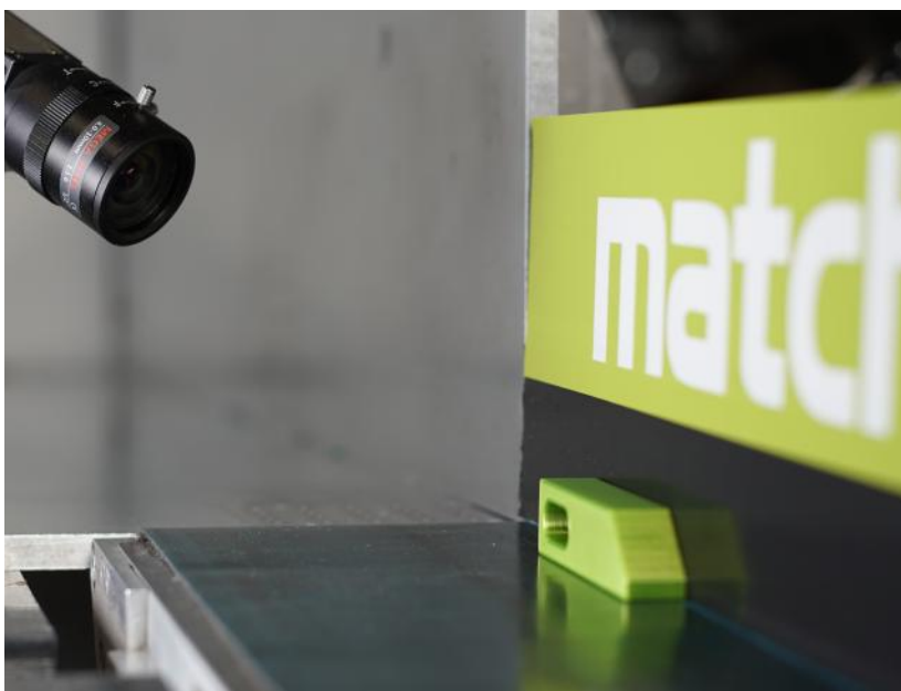
Hochgeschwindigkeitskamera zur Teileidentifikation in einer aerodynamischen Zuführanlage. Foto: match
