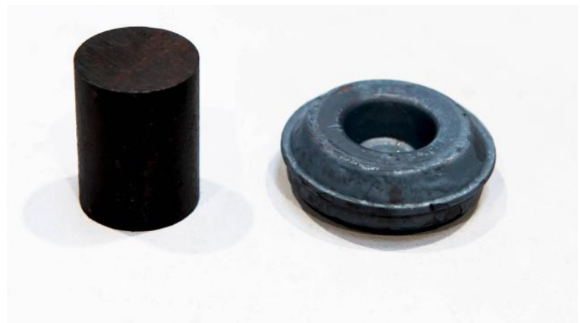
Zusammenarbeit zwischen Mensch und Roboter in der Praxis (v. l. n. r.): Die Anlage wird vorbereitet, der Roboter positioniert das vorgeheizte Werkstück in der Presse, die Presse bearbeitet das Werkstück, Rohling und Pressling nebeneinander. Fotos: Helge Bauer
