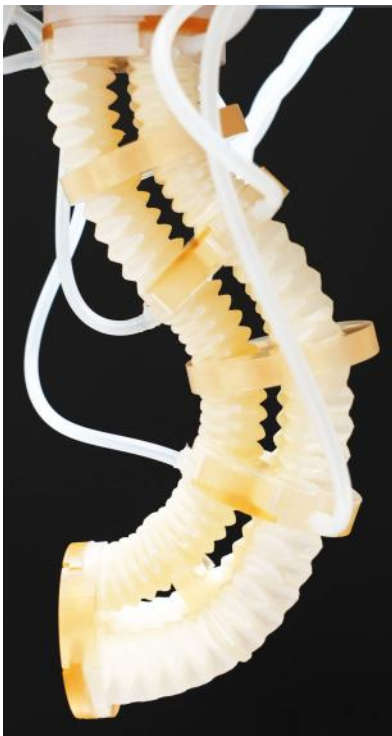
Links: „Soft Material Robotic Systems“ – die Verwendung weicher Materialien verringert die Verletzungsgefahr. Rechts: Transport großer Bauteile durch kooperierende, mobile Roboter. Fotos: match
