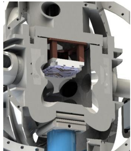
Links: Konstruktion des miniaturisierten Gyroskops, rechts: Detail, das den Atomchip zeigt. Konstruktion: IQO und IMPT
