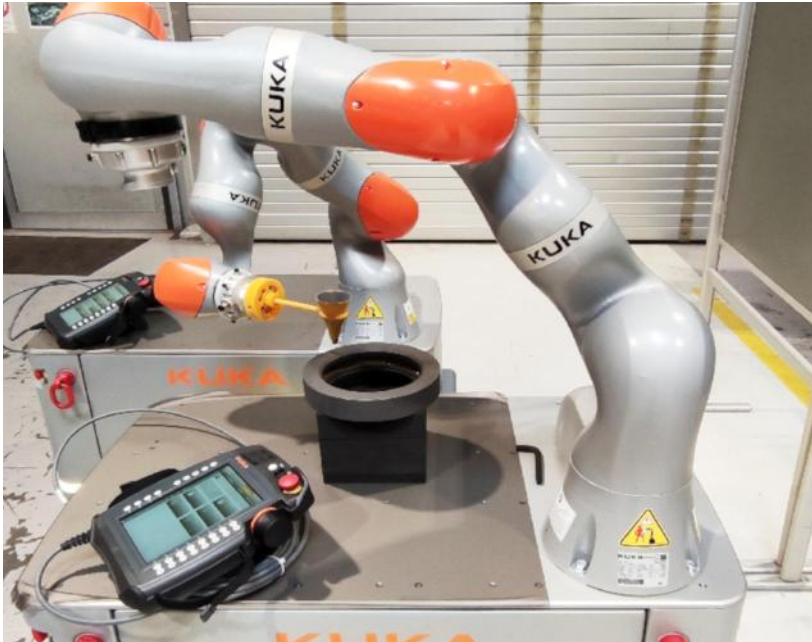
Kooperierende mobile Roboter am ITA beim Befüllen einer Sinterform. Foto: P. Bakhteev
