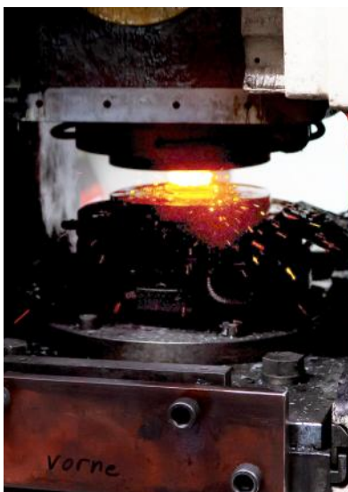
Zusammenarbeit zwischen Mensch und Roboter in der Praxis (v. l. n. r.): Die Anlage wird vorbereitet, der Roboter positioniert das vorgeheizte Werkstück in der Presse, die Presse bearbeitet das Werkstück, Rohling und Pressling nebeneinander. Fotos: Helge Bauer
