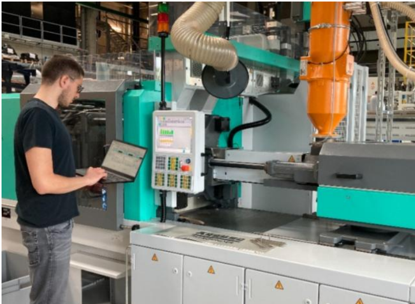
Leistungsmessungen an der Spritzgießmaschine Arburg 470 A. Foto: IKK, Stefan Kerkenberg
