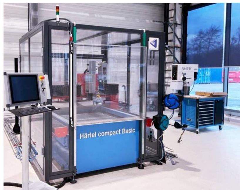
Wasserstrahlschneidanlage Härtel compact Basic, Härtel Laser + Wasser GmbH & Co. KG. Foto: IKK
