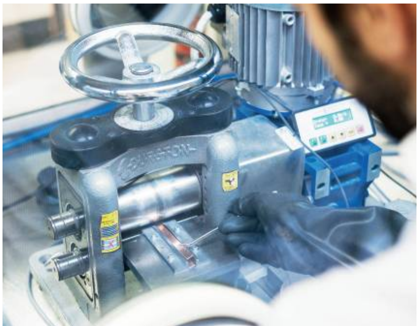
Vorbereitung einer Probe in einer Handschuhbox in sauerstofffreier Umgebung. Foto: Leo Menzel
