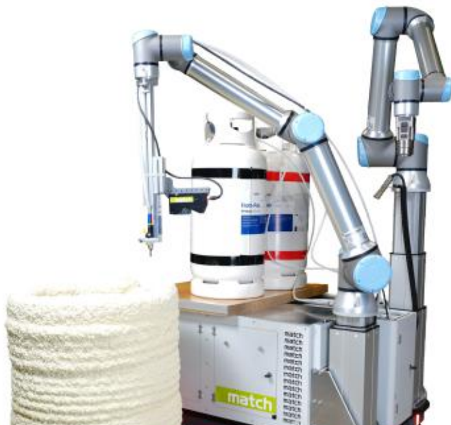
Mobile Roboterplattform MIR 600 mit Aufbau zur Untersuchung additiver Fertigung mittels mobiler Roboter. Foto: match
