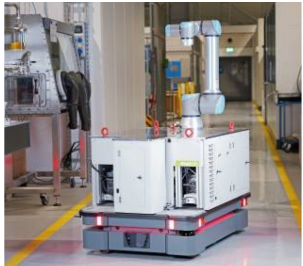
Mobile Roboterplattform MiR600 mit MRK-fähigem UR16e Leichtbaurobster. Foto: match
