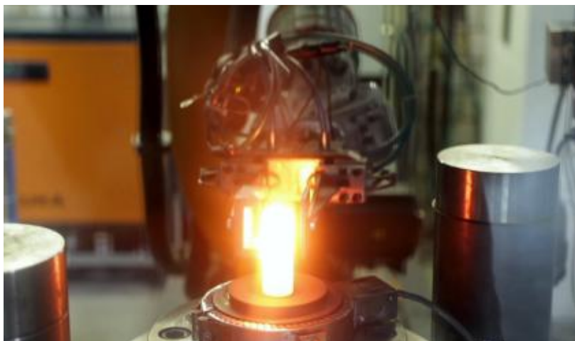
Glühendes Halbzeug vor der Umformung. (Foto: ELSA)
