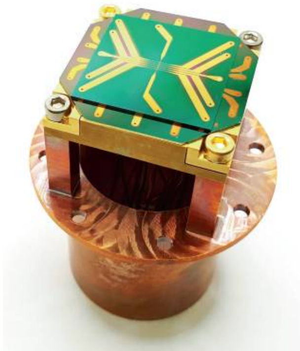
Das Atomchip-System als Herzstück eines Quantengravimeters. Foto: IMPT
