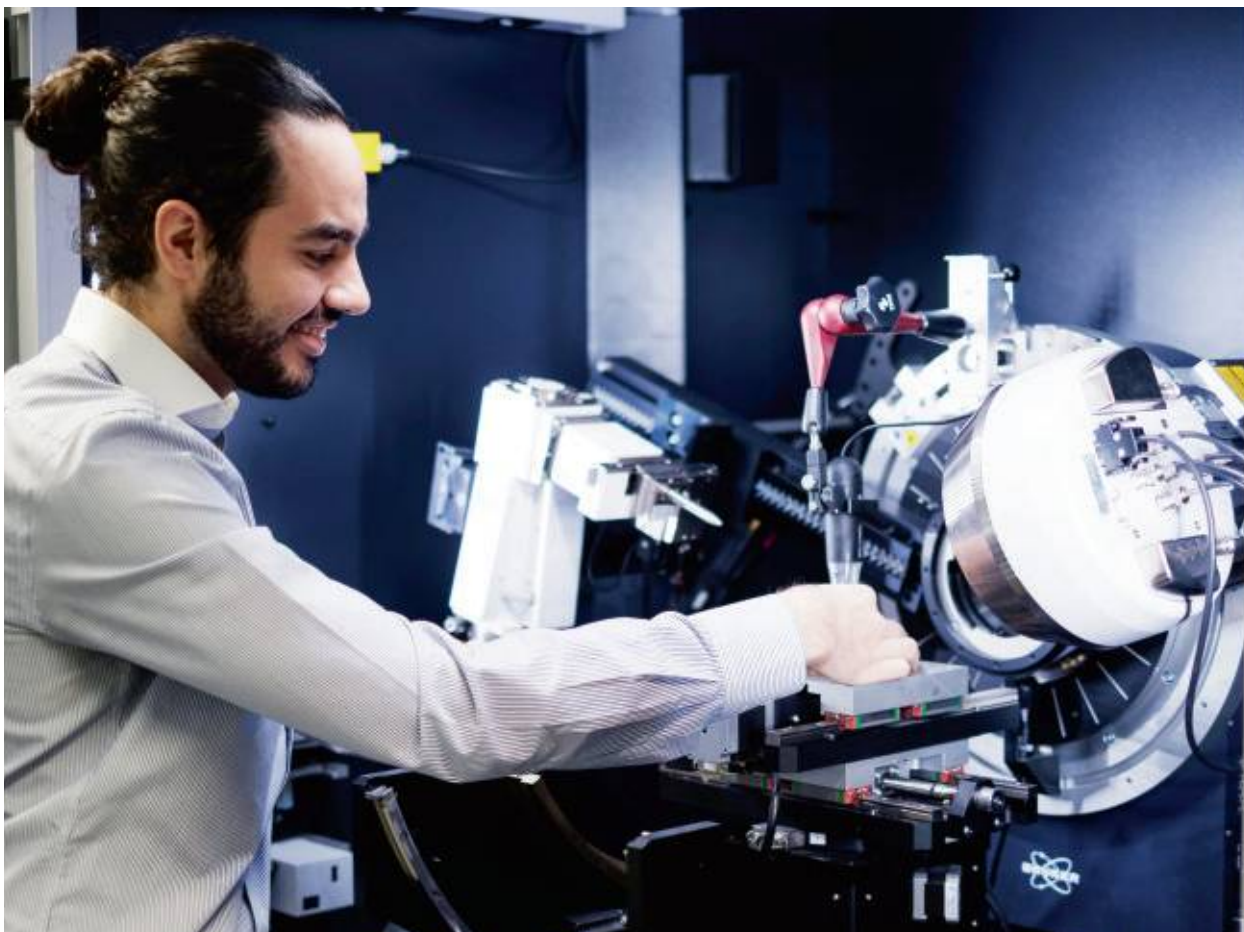
Khemais Barienti, Mitarbeiter im SFB, bereitet eine Probe zur Röntgenuntersuchung vor.
