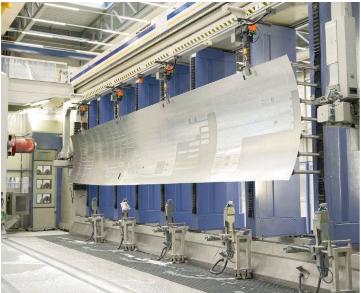
3D-Flächenfräsanlage zur Bearbeitung von Hautfeldern
