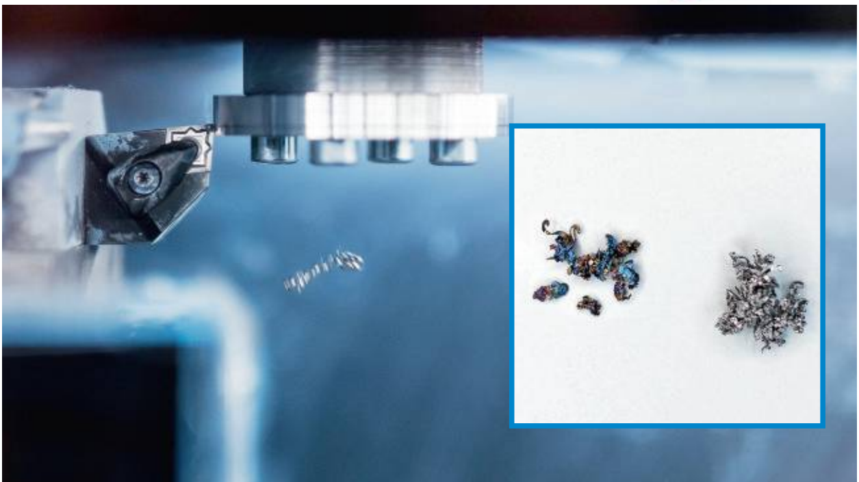
Zerspanen einer Probe in sauerstofffreier Atmosphäre. Kleines Bild: herkömmlich erzeugte Titanspäne (links) mit den typischen, durch Oxidation hervorgerufenen Verfärbungen, rechts Späne, die ohne Sauerstoffeinfluss hergestellt wurden. Das schont das Werkzeug und als Bonus lassen sich die Späne auch noch besser recyceln.
