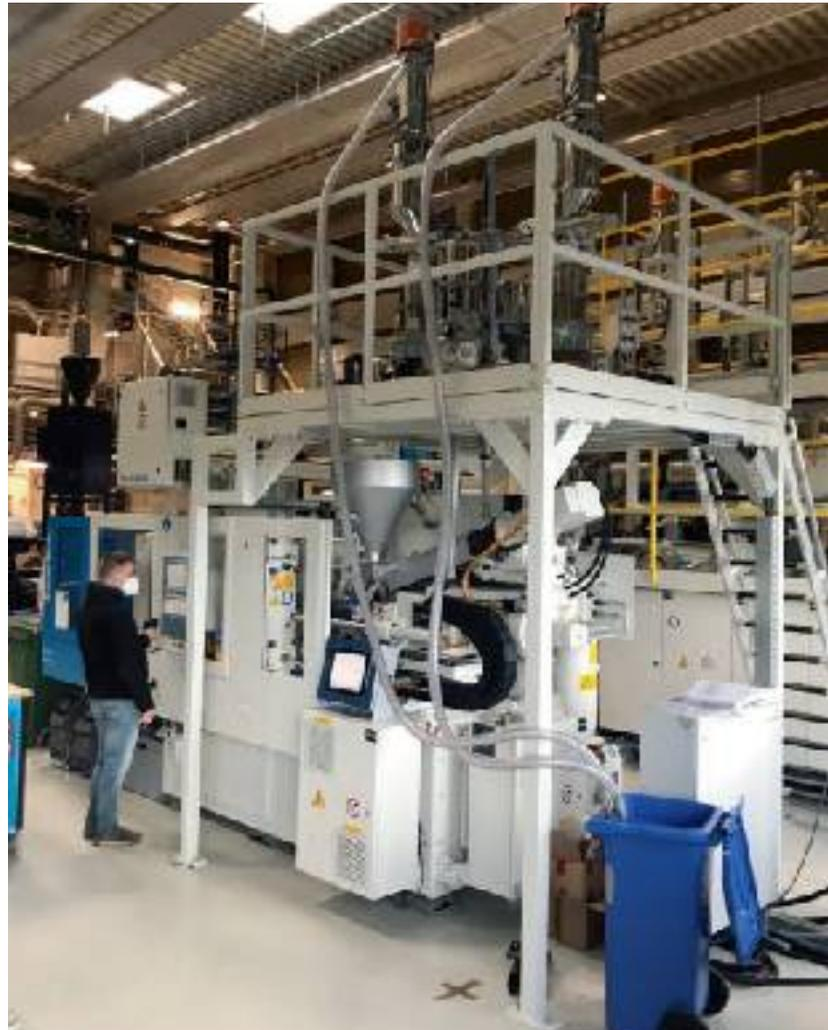
DCIM (Direct Compounding Injection Molding) der KraussMaffei Group GmbH zur optimalen Entwicklung von Rezyklat-Rezepturen. Foto: IKK
