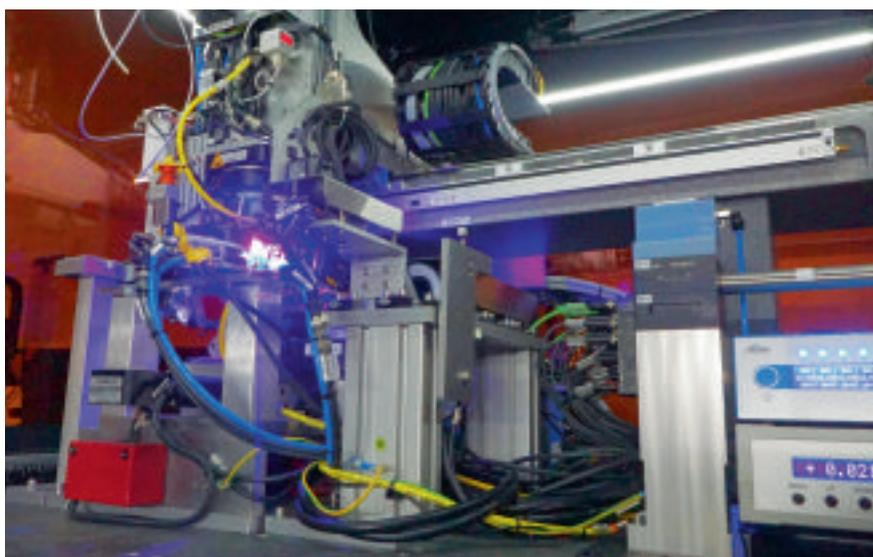
Oben: Sensormodul des quantenzählenden Computertomographen,
