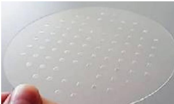
Glasmembran: LIDE-Verfahren, Membrandicke 9µm. Belastbarkeit über 1 bar Druckdifferenz. Foto: IMPT
