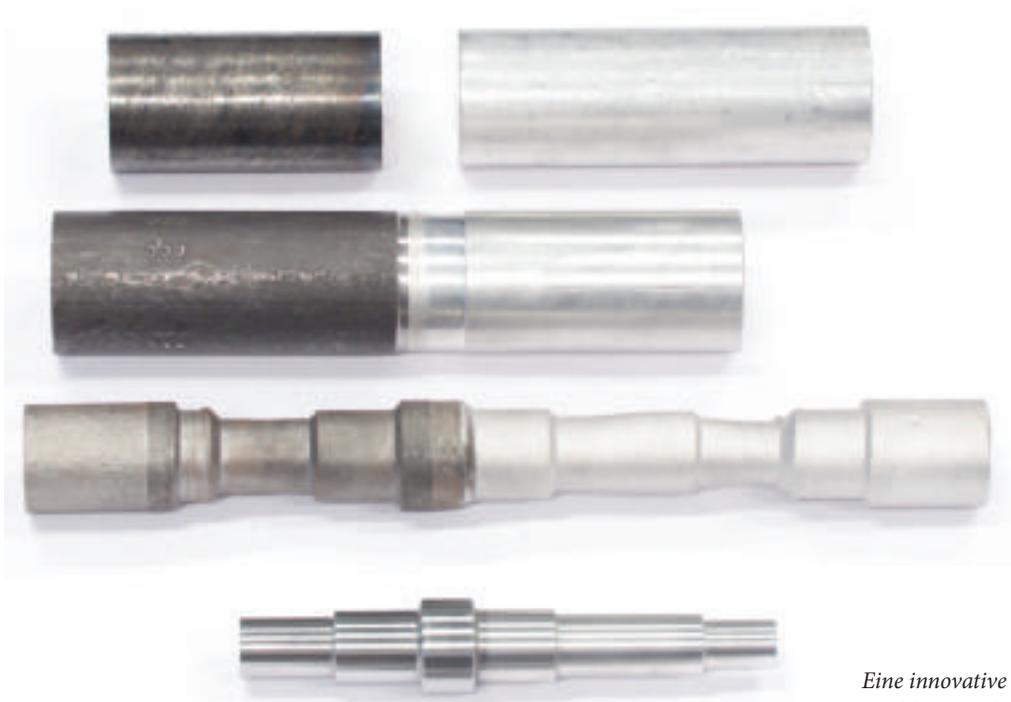
*Eine innovative Prozesskette erlaubt, Hochleistungsbauteile aus zwei verschiedenen Werkstoffen schon vor der Umformung zu fügen.*
