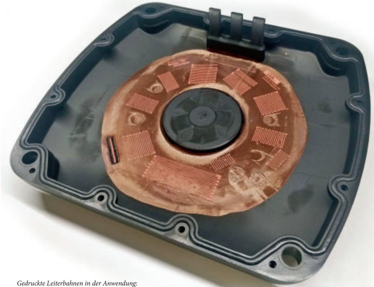
*Gedruckte Leiterbahnen in der Anwendung:
