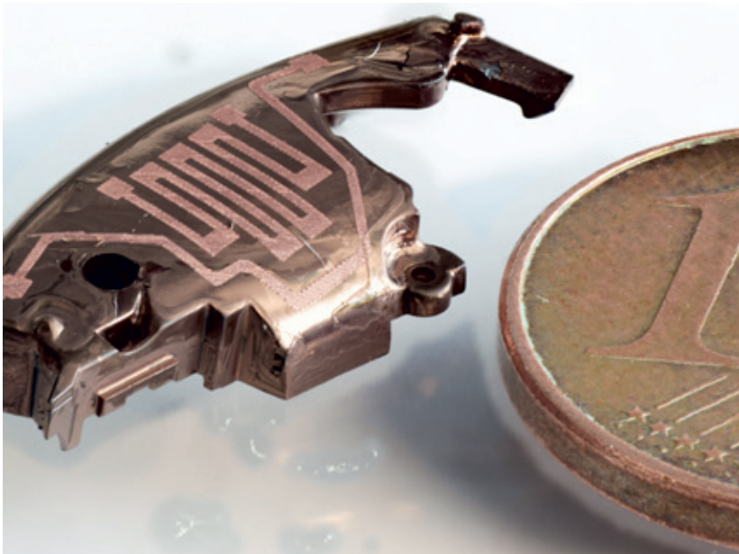
Hörgerätebauteil mit gesinterten Leiterbahnen (Foto: J. Stelling, ITA)
