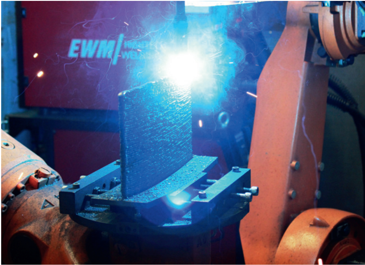
Fertigung einer Referenzwand mittels WAAM (Wire and Arc Additive Manufacturing) für die Bestimmung der mechanischen Eigenschaften Foto: IW
