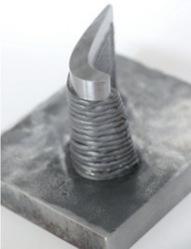
Additive Fertigung komplexer Investitionsgüter – hier eine durch Aufschweißen und Fräsbearbeitung produzierte Turbinenschaukel. Foto: IFW
