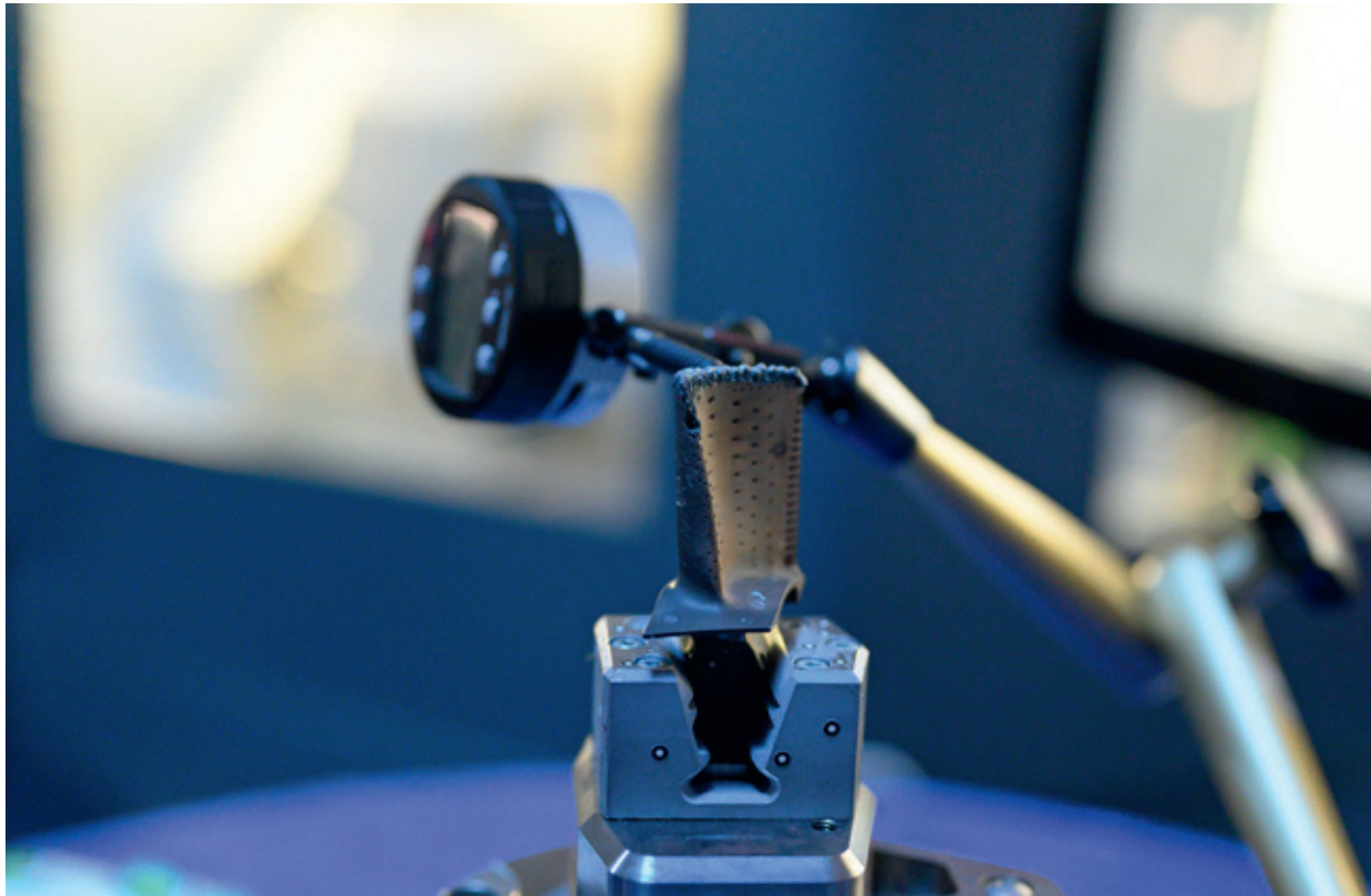
In der Frästechnik wirken Prozesskräfte, die die Genauigkeit in der Fertigung negativ beeinflussen. Am IFW wird erforscht, die Genauigkeit durch Abdrängungskompensation bereits im Fräsprozess – also ohne Nachbearbeitung – zu erreichen. Hier am Beispiel einer aufgeschweißten Turbinenschaukel. Foto: IFW.
