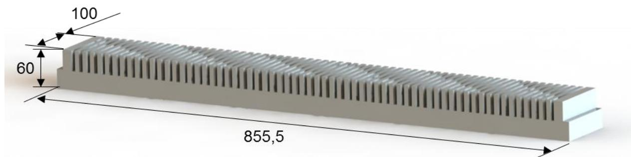
Bild 7-6: Eisenkern des Motors
