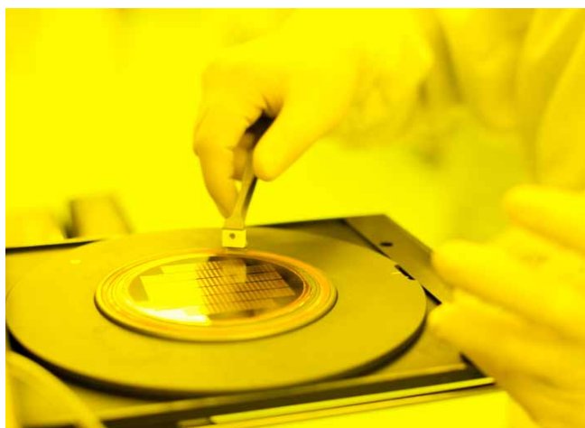
Mitte: 14 Masken und etwa 300 Einzelschritte sind erforderlich, um die Mikromagnetik auf dem Wafer aufzubauen. Hier justiert Henry Saalfeld die Maske, bevor er mit der Fotolithografie beginnt.
