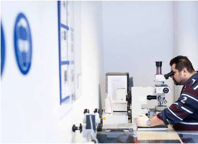
Links: Srećko Cvetković prüft unter dem Lichtmikroskop, ob das chemisch-mechanische Polieren des Wafers erfolgreich war. Rechts: Das Chiplet – man kann es leider nicht sehen – wird montiert. Die ruhige Hand gehört Dominik Hoheisel.
