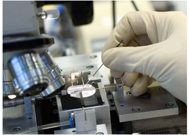
Links: Srećko Cvetković prüft unter dem Lichtmikroskop, ob das chemisch-mechanische Polieren des Wafers erfolgreich war. Rechts: Das Chiplet – man kann es leider nicht sehen – wird montiert. Die ruhige Hand gehört Dominik Hoheisel.
