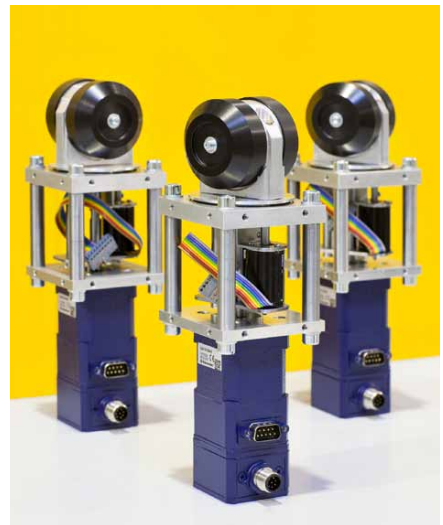
Die CogniLog-Rollen sind auch mechanisch eine Herausforderung: Jede einzelne braucht einen Antrieb, damit sie autonom agieren kann. Viel Platz ist dafür nicht. Oben: Nicht nur simuliert - hier müssen die Stapler-Repräsentanten-Fahrzeuge wirklich wissen, was sie tun.
