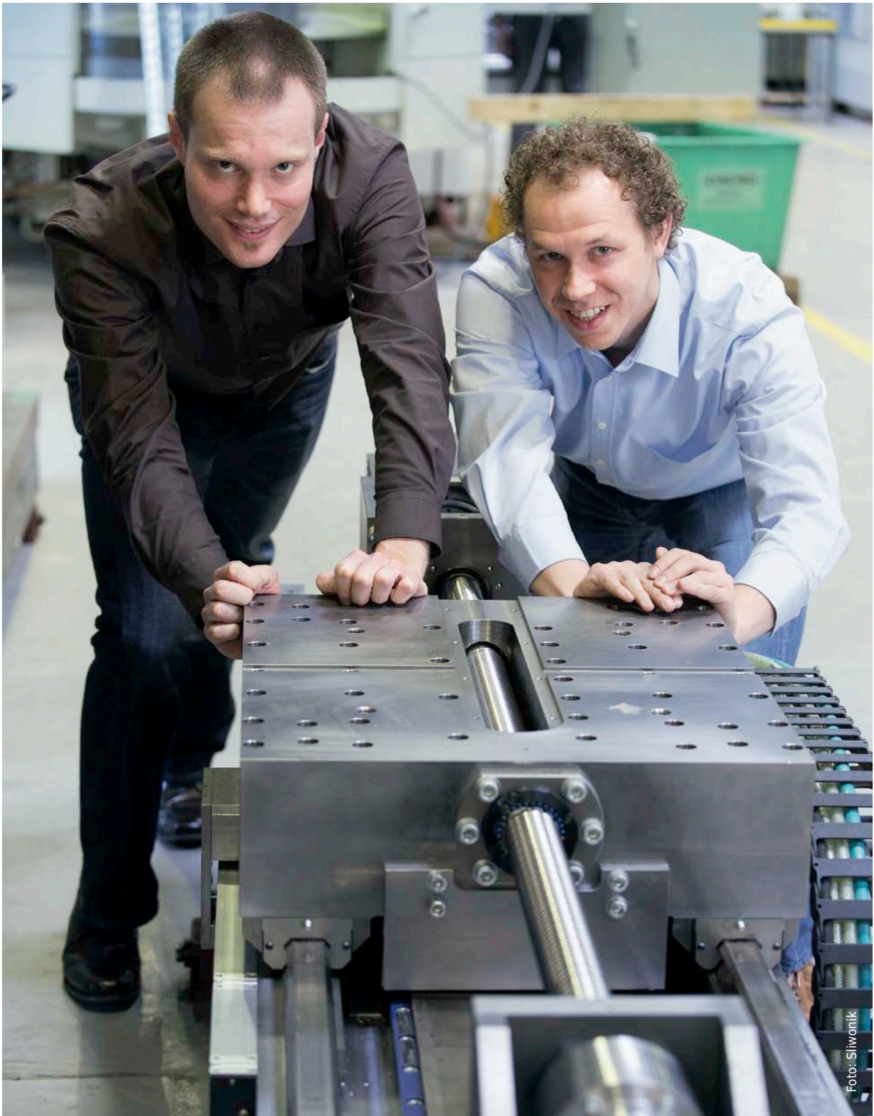
Lars Hüsemeyer (links) und Dominik Dahlmann demonstrieren eine Komponente der neuen, effizienten Maschine: Selbst ein stillstehender Schlitten muss normalerweise von einem Antriebsmotor in Position gehalten werden. Hier hält eine Bremse die Achse fest. Wie man sieht, unverrückbar. Der Motor hat Pause.
